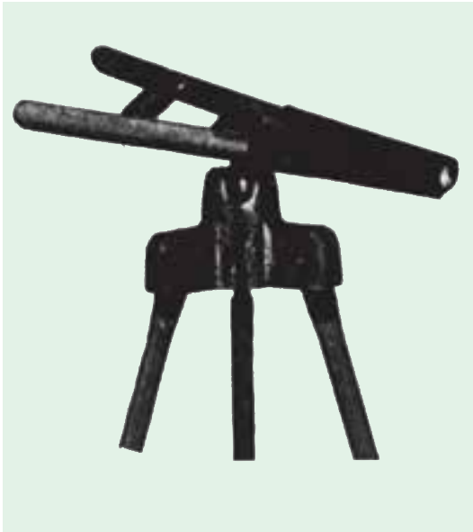
شکل ۳-۳- ژالون گیر و نحوه‌ی به کارگیری آن
