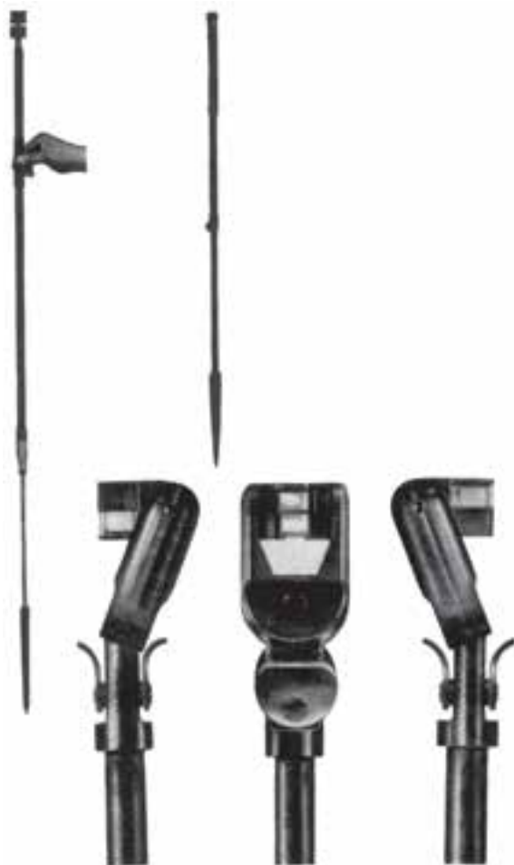
شکل ۸-۳- گونیای منشوری و پایه‌ی مخصوص آن
