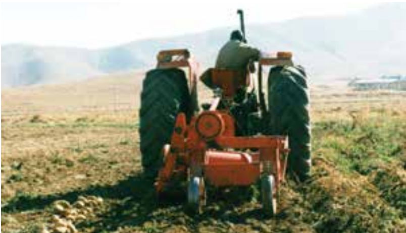
ب - سیب‌زمینی‌کن در حال عملیات برداشت
