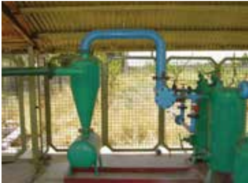
شکل ۲۷-۶- نحوه کار سیکلون و شکل ظاهری آن
