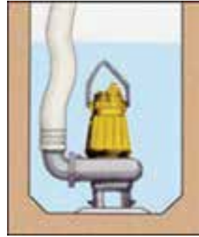
شکل ۸-۵- نصب پمپ کف کش در چاهک
