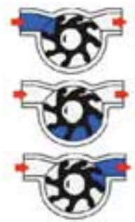
شکل ۳-۱۶- طرز کار پمپ
