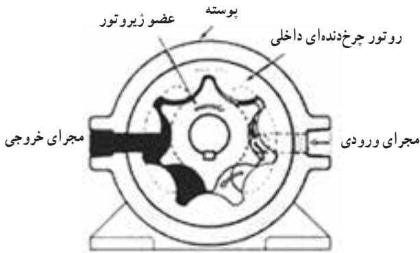
شکل ۳-۷- طرز کار پمپ ژیروتور
