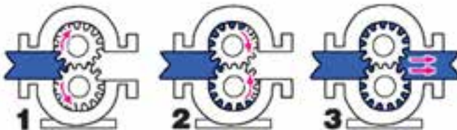
شکل ۱-۳- مراحل کار پمپ دنده خارجی
