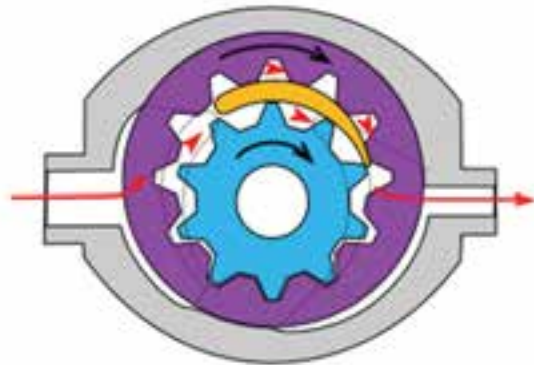
شکل ۳-۴- اجزای ساختمانی پمپ دنده داخلی
