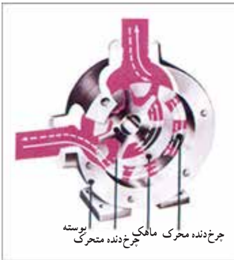
شکل ۳-۵- طرز جریان سیال در پمپ دنده داخلی
