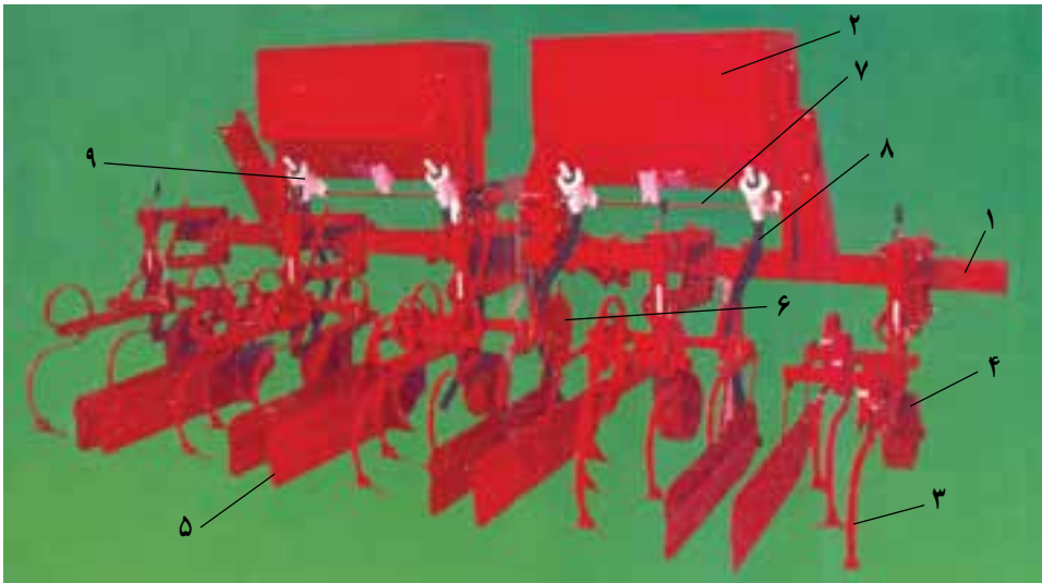
۱- شاسی ۲- صندوق کود ۳- شاخه ۴- چرخ ۵- سپر محافظ ۶- چرخ ستاره ای محرک موزع کودپاشی ۷- محور موزع ها ۸- لوله سقوط کود ۹- موزع شکل ۵-۲- پنجه - کودریز
