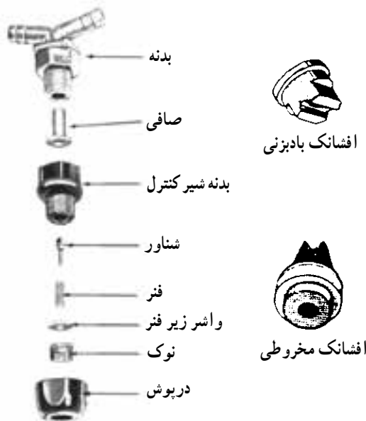
شکل ۴-۳- دو نوع افشانک بادبزنی و مخروطی و اجزای افشانک سم پاش
