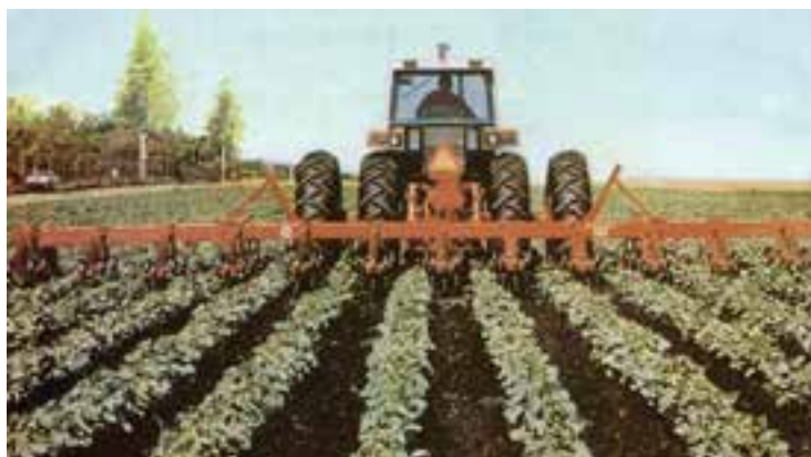
شکل ۱-۱- عملیات وجین با پنجه در کشت ردیفی
