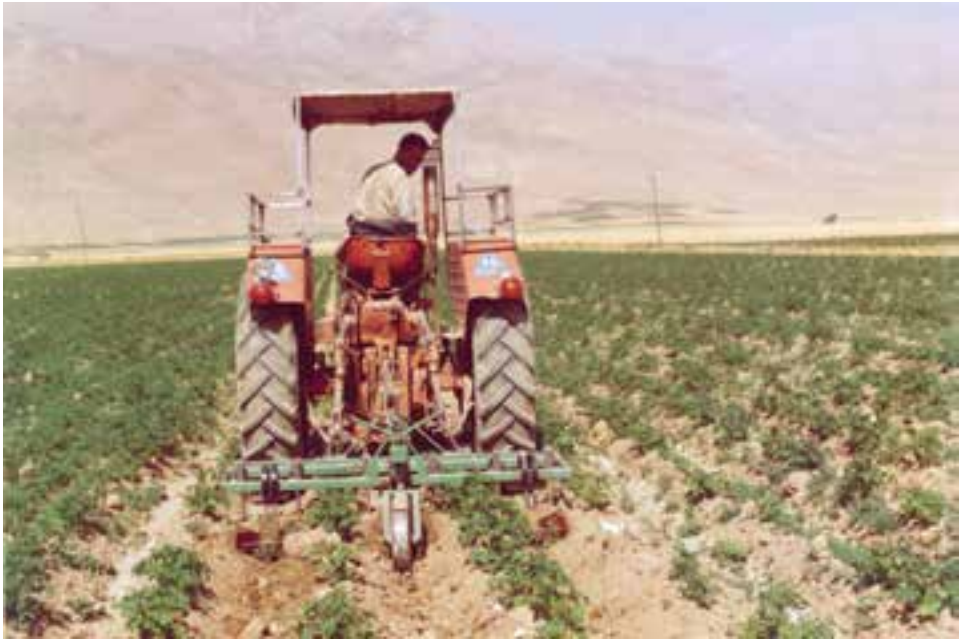
شکل ۱-۲- پنجه پشت تراکتور
