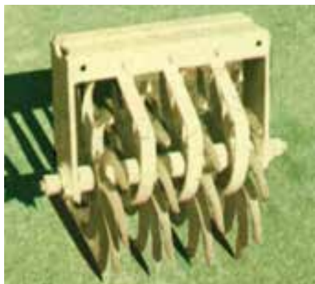
شکل ۱۰-۱- یک واحد چرخ پره پنجه غلتان
