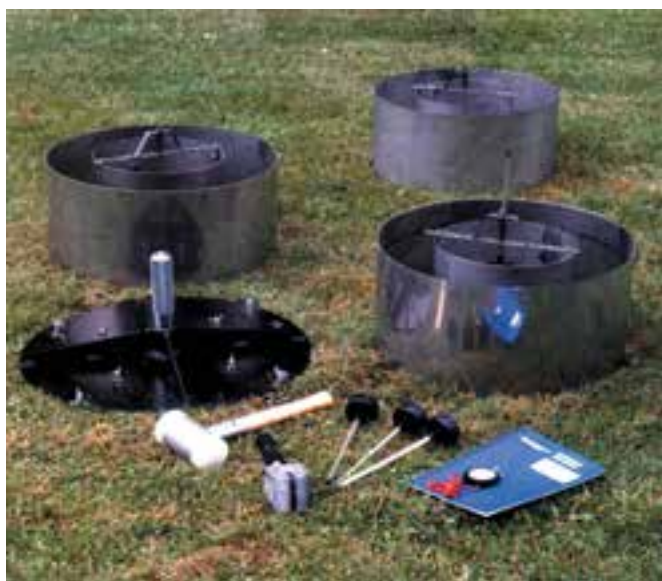
شکل ۱-۳ استوانه مضاعف وسیله اندازه گیری نفوذپذیری
