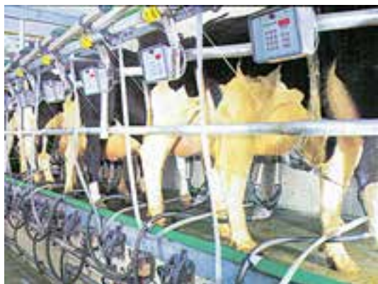
مخزن مدرج شیر می باشند و دارای یک کنترل کننده ی رایانه ای هستند (شکل ۴-۵۴).
