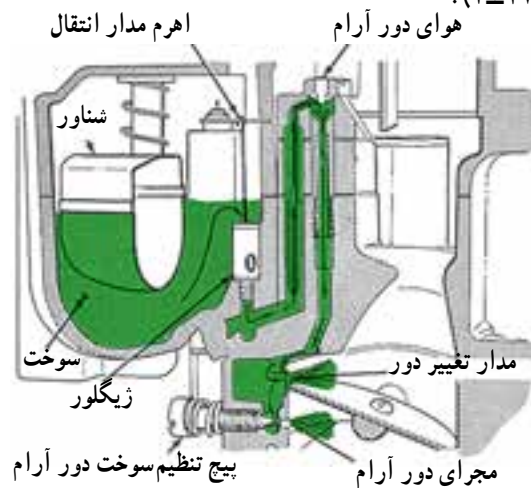
شکل ۴-۱۶- مدار دور آرام
