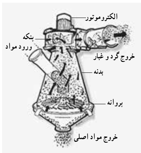
شکل ۲-۷- طرح کلی تمیزکننده گردبادی
