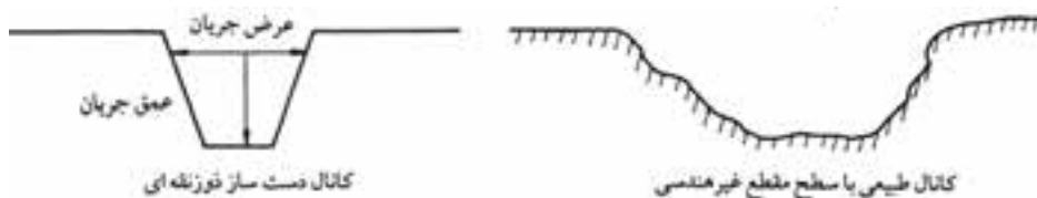
شکل ۵-۷- مقایسه کانال‌های با سطح مقطع هندسی و غیر هندسی
