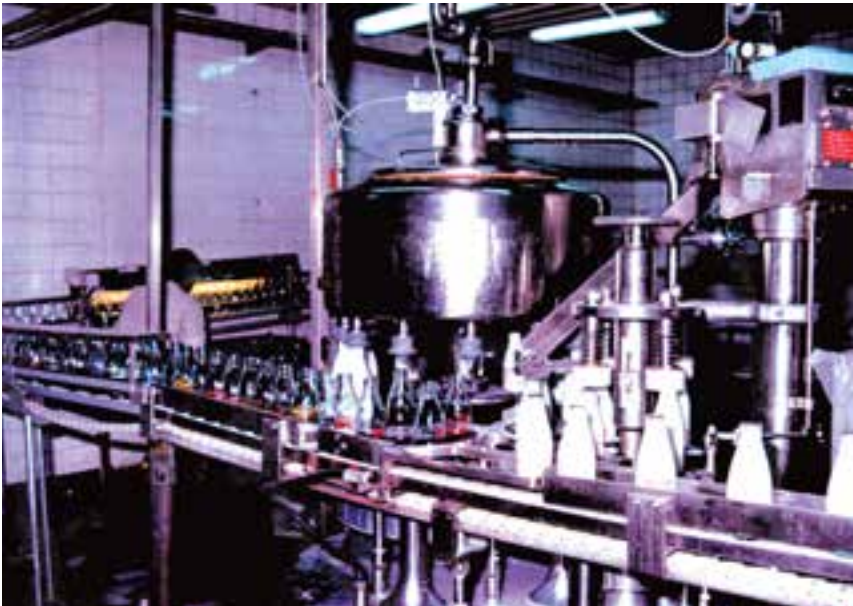
شکل ۴-۸ - دستگاه پرکن بطری‌ها، در سمت راست تصویر دستگاه تشک‌زنی قرار دارد.
