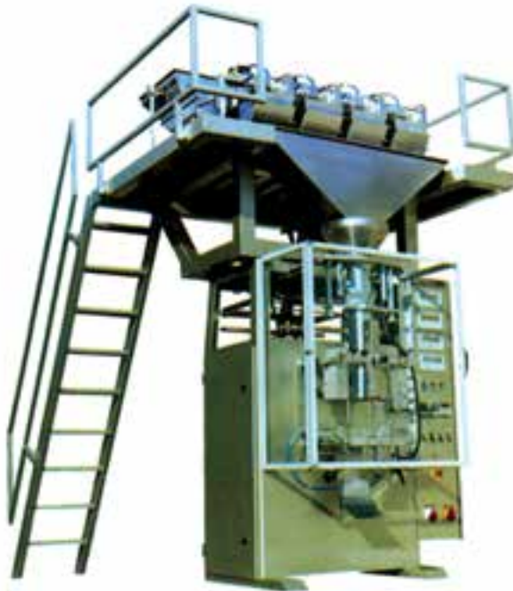
شکل ۲-۸ - ماشین بسته‌بندی برنج، چای، خشکبار، چیپس، تافی، آبنبات، بیسکویت و غیره
