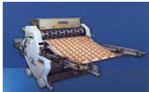
شکل ۱۶-۳- ماشین قالب‌زن دوار
