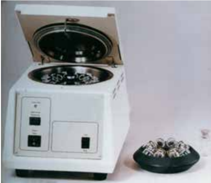
شکل ۱۰-۲- نمونه‌ای از دستگاه سانتریفوژ آزمایشگاهی
