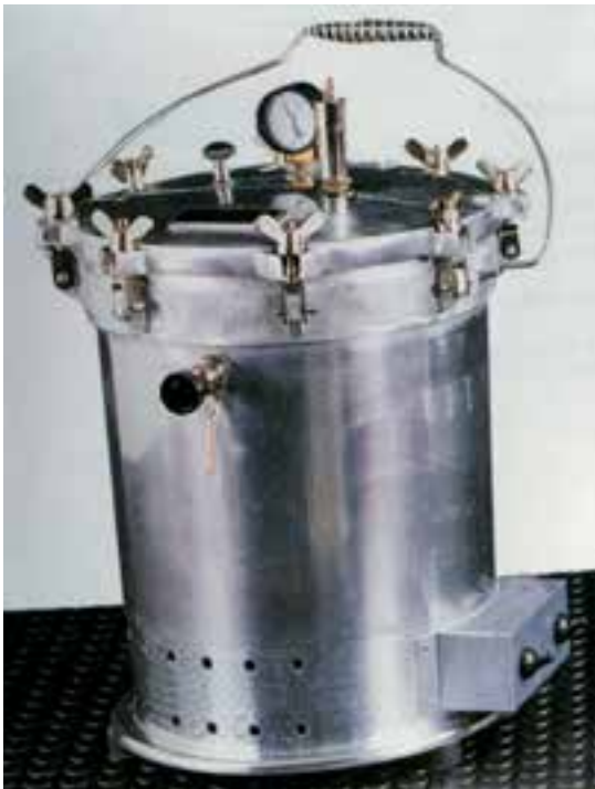
شکل ۱۳-۲- نمونه‌ای از دستگاه اتوکلاو مخصوص استریل کردن با بخار تحت فشار
