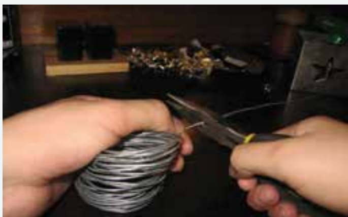
تصویر ۶۸-۱ طرز کاربرد سیم چین، دم باریک
