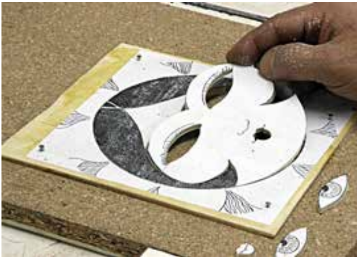
شکل ۸-۲۰ ب - برش قالب به قطعات کوچک تر
