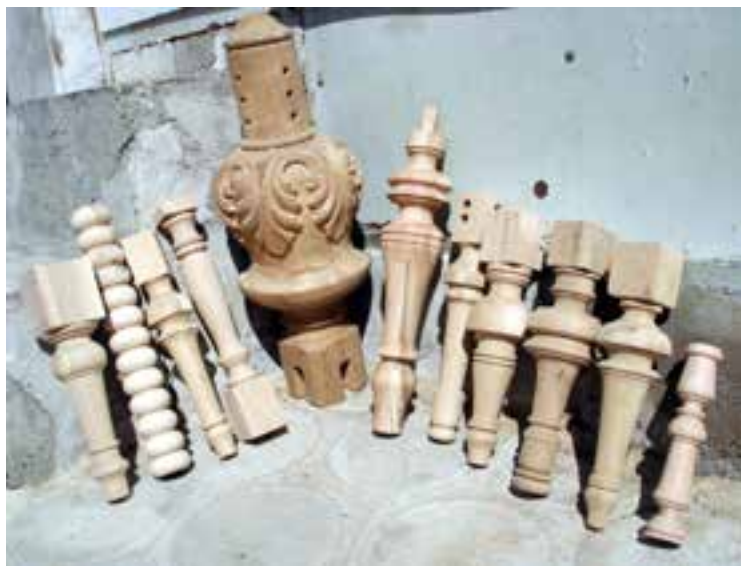
شکل ۸-۱۰ - اشیای خراطی شده (نرده، پایه میز و صندلی)
