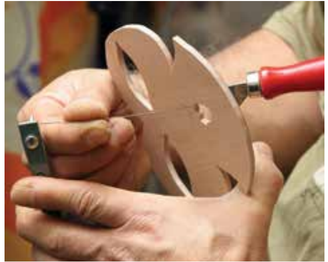
شکل ۸-۲۰ ب - برش قالب به قطعات کوچک تر
