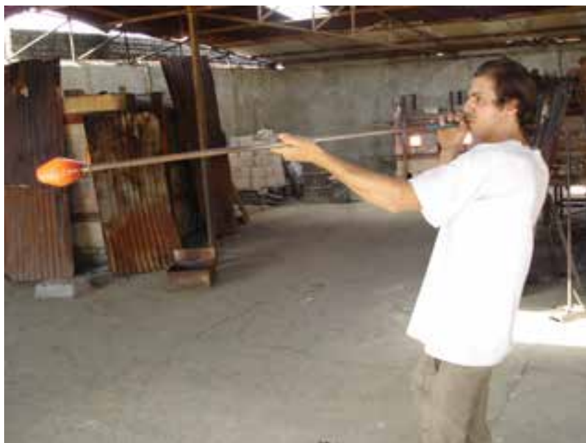
شکل ۷-۹- دمیدن در لوله‌ی دم
