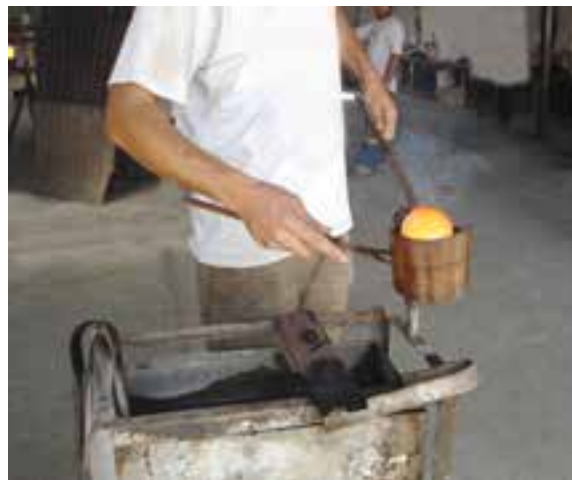
شکل ۷-۸- قاشقی کردن بار
