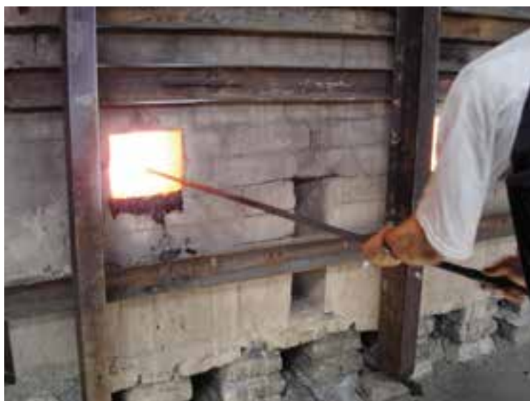
شکل ۷-۶ - مذاب شیشه در کوره (بارگیری)
