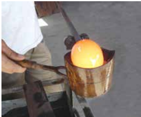
شکل ۷-۸- قاشقی کردن بار
