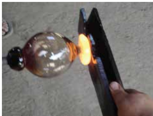
شکل ۱۱-۷- مراحل شکل‌دهی پایه شیء
