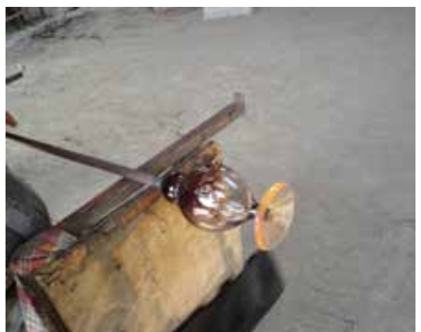
شکل ۱۱-۷- مراحل شکل‌دهی پایه شیء
