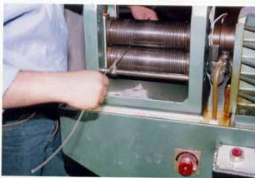
شکل ۱۱-۶-ج - حدیده کاری برای تهیه‌ی مفتول نقره
