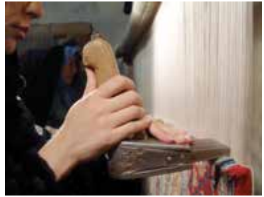
شکل ۲۵-۵-و- دفتین زدن
