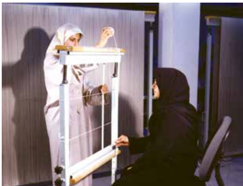
شکل ۲۵-۵- الف چله کشی قالی
