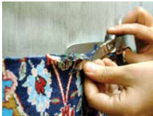
شکل ۲۵-۵-ح- قیچی کاری دستی
