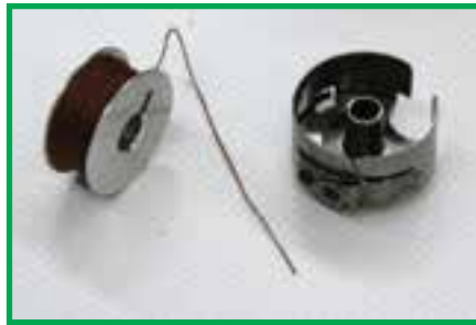
شکل ۶-۸ - ماسوره، ماکو و قاب ماکو
