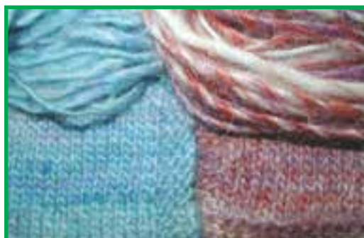
شکل ۷-۳ نخ با تاب کم و پارچه بافته شده از آن
