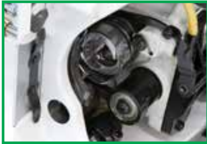
شکل ۶-۸ - ماسوره، ماکو و قاب ماکو
