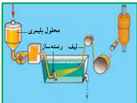
شکل ۱۱-۶- مراحل تولید نخ یک سره با روش تر ریسی
