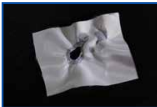
شکل ۱۰-۴ اثر استن بر پارچه استات
