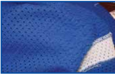
شکل ۱۱-۵- ایجاد پُزدانه در پلیور از جنس آکرلیک
