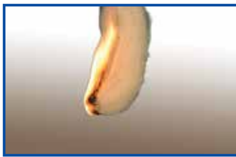
شکل ۳-۶ سوختن الیاف پشم
