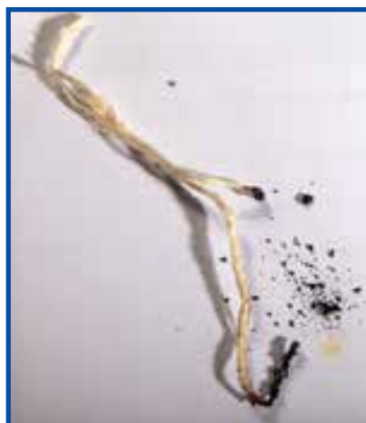
شکل ۱۶-۳ خاکستر حاصل از سوختن الیاف ابریشم
