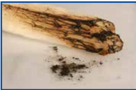
شکل ۳-۷ خاکستر حاصل از سوختن الیاف پشم
