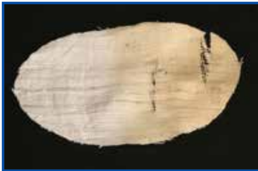
شکل ۲-۶- تجزیه پارچه پنبه‌ای در دمای ۱۵۰ درجه سانتی‌گراد
