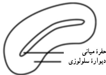
شکل ۲-۸- مقطع عرضی لیف پنبه
