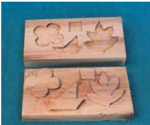
تصویر ۸-۱۰-۳- در روی یک قطعه چوب، زمینه به عمق ۴ میلی‌متر و در روی چوب دیگر متن به همان اندازه گود شده است.
