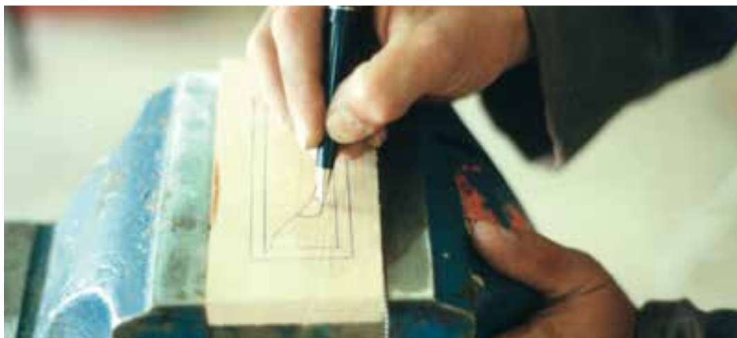
تصویر ۳-۹-۳- رسم خط به روی یک قطعه چوب
