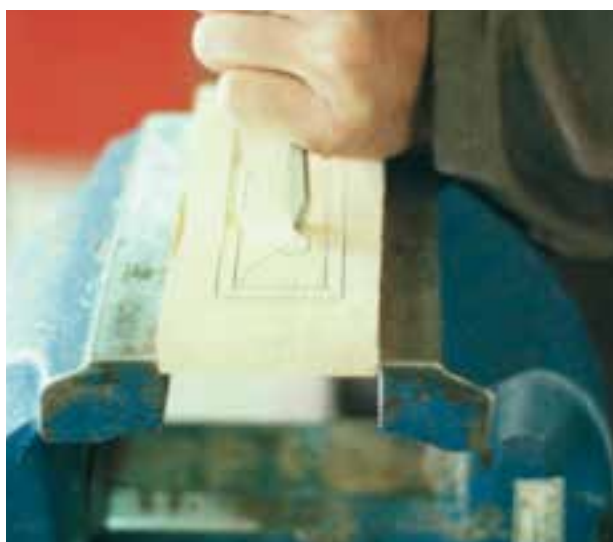
تصویر ۳-۹-۵- نحوه دورگیری به وسیله مغار تخت
