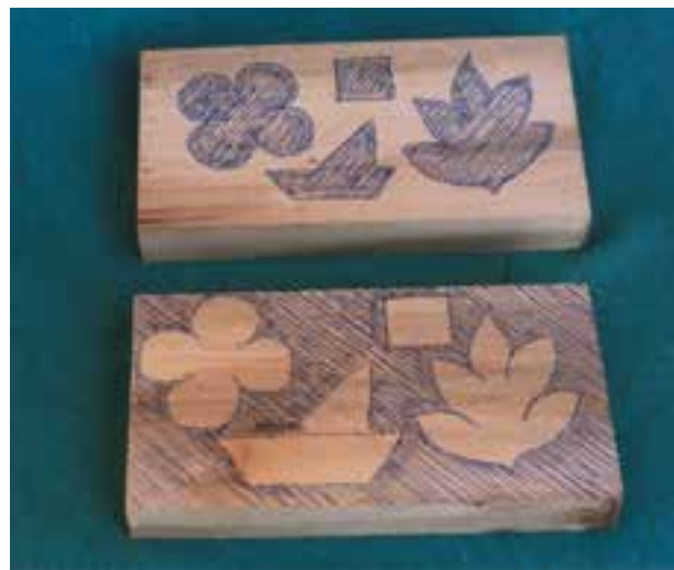
تصویر ۷-۱۰-۳- رسم اشکال ساده به روی دو قطعه چوب (در روی یکی، زمینه پرداز خورده و در روی دیگری، متن پرداز خورده است)
