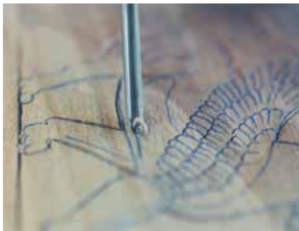
تصویر ۳-۱۵-۶- شیوه گود کردن شیارهای دورگیری به وسیله مغار شفره
