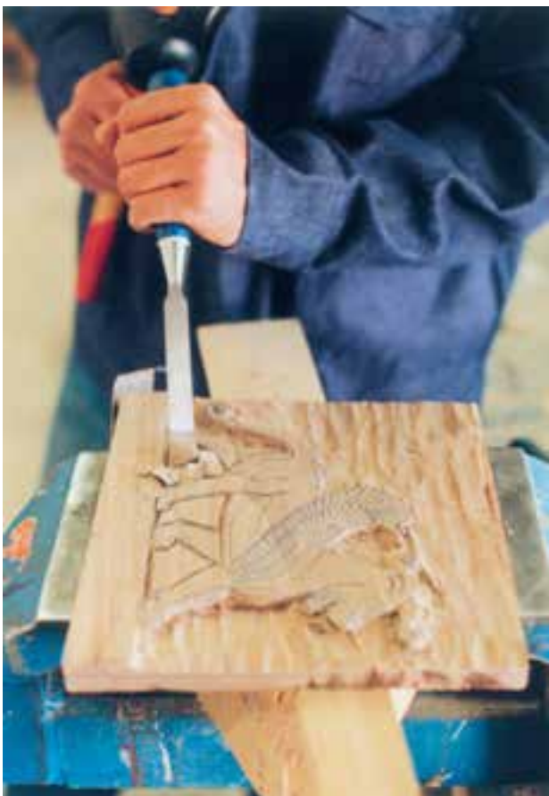
تصویر ۳-۱۵-۹- کندن زمینه به وسیله مغار تخت
