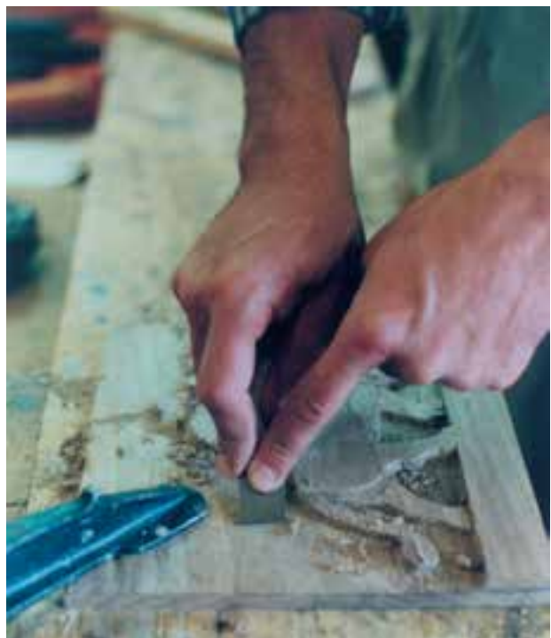
تصویر ۱۱-۱۵-۳- صاف نمودن کف زمینه به وسیله مغار
