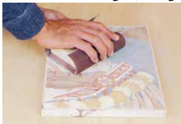
تصویر ۱-۱۳-۲- سایش یک تابلوی معرّق بوسیله سمباده
