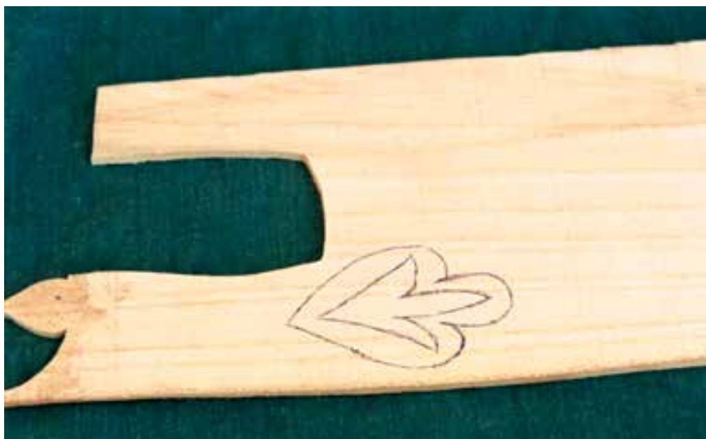
تصویر ۱۶- ۸- ۲- ترسیم یک شکل توخالی ساده روی لایه چوبی
