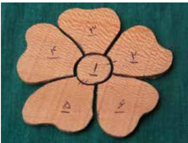
تصویر ۱۴-۸-۲- قطعات بریده شده شکل در روی یک سطح صاف در کنار هم چیده می شوند تا از برش صحیح مطمئن شویم.
