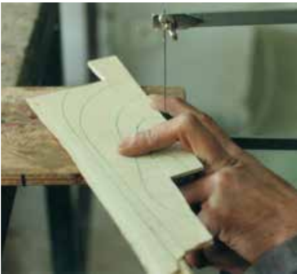
تصویر ۲ - ۷ - ۴ - شیوه گرفتن قطعه در حال برش روی لبه کار
