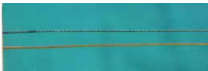
تصویر ۴-۵-۲- مقایسه تیغه‌اره چوب‌بُر و فلزبُر بالایی — چوب‌بُر پایینی — فلزبُر
