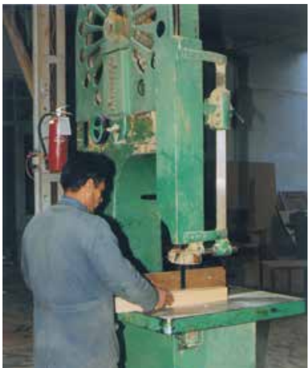
تصویر ۵-۴-۲- چگونگی لایه کردن چوبهای مصرفی در معرق به ضخامت ۳ میلیمتر، لایه کردن به وسیله دستگاه اره کلافی (ماشین اره)
