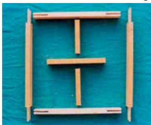
تصویر ۸-۶-۲- قطعات آماده شده برای ساخت کلاف تابلو
