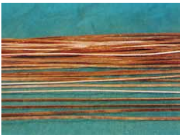
تصویر ۷-۴-۲- نوارهای مسی به ضخامت یک میلیمتر و عرض دو میلیمتر که می‌توان آنها را در شیوه معرق جایگزینی در حاشیه قطعات کوبید.
