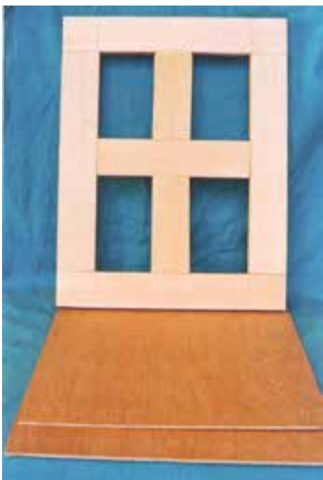
تصویر ۹-۶-۲- کلاف آماده شده و دو عدد سه لایه که بر پشت و روی آن چسبانیده می شود.
