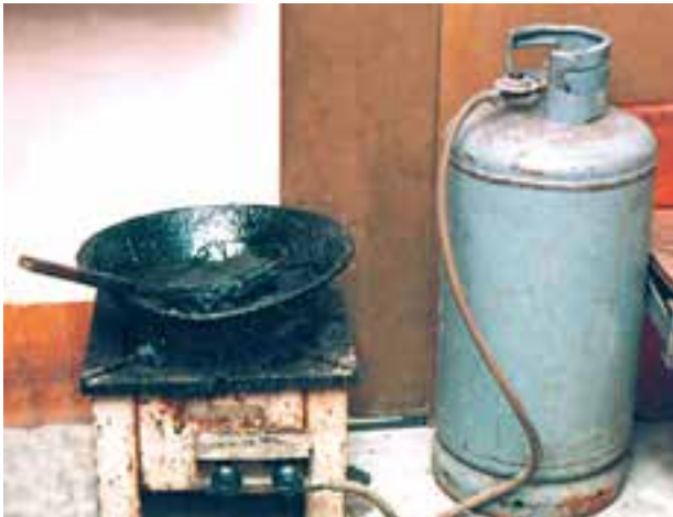
شکل ۳۰-۲- اجاق و ظرف ذوب قیر
