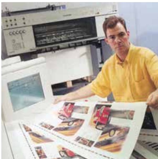
شکل ۳۵-۶- کنترل رنگ از طریق نوار کنترل
