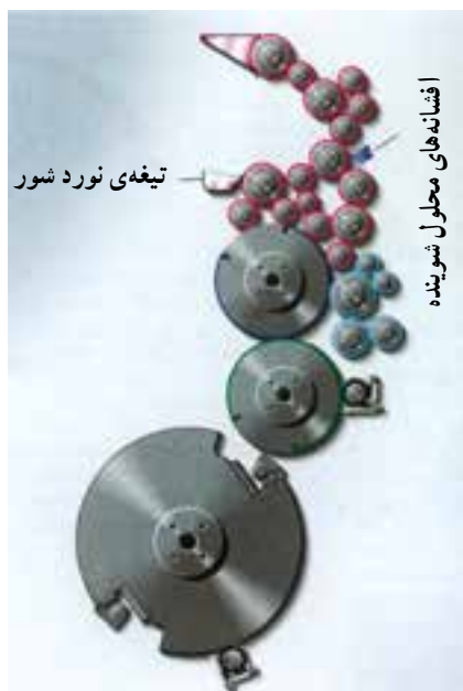
شکل ۶-۷- سیستم شست‌وشوی اتوماتیک نوردهای مرکب
