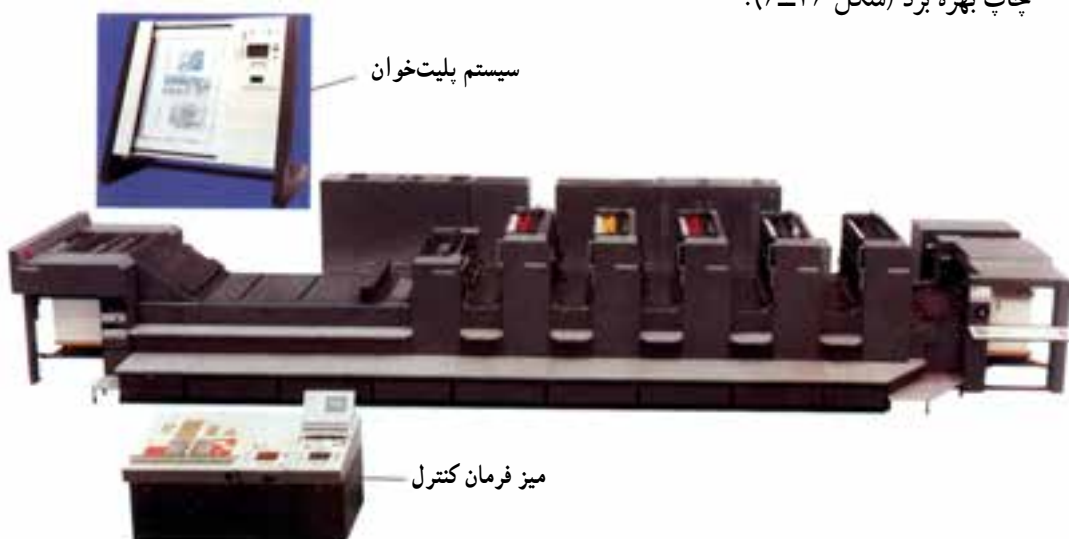
شکل ۲۶-۶— ماشین چاپ مجهز به میز فرمان برای تنظیمات از راه دور، نظارت بر تولید و سیستم پلیت‌خوان (SM102/CP31/Data Control)
