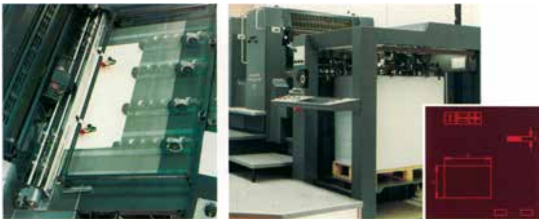
شکل ۱۳-۶- پیش تنظیمات اتوماتیک واحد تغذیه
