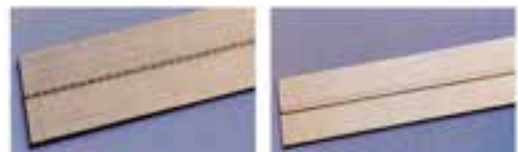
شکل ۷-۵- ورق‌های فلزی پرفراژی، قابل نصب روی سیلندر لاستیک با نوارهای خط‌زنی و پرفراژ که روی ورق چسبانده می‌شوند.
