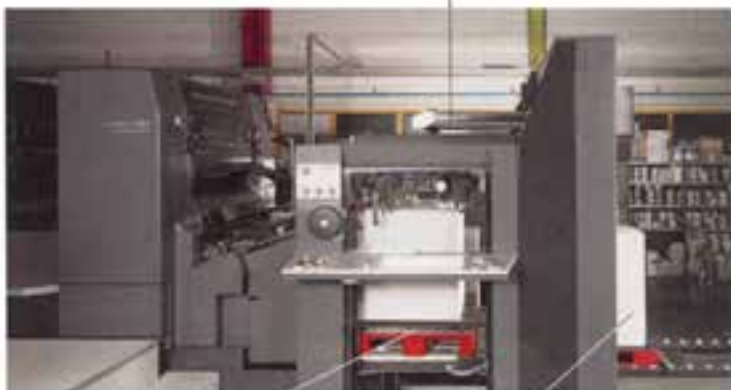
پالت آماده به تغذیه تخته پالت دارای شیارهای ورودی برای چنگک
