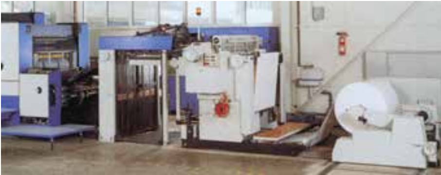
شکل ۱۲-۵- سیستم تبدیل رول به ورق (رول بازکنی)
