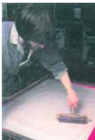
شکل ۱۱-۱۹- عملیات انتقال استنسیل به سطح توری را نشان می دهد. پس از انتقال، حدود دو ساعت برای خشک شدن توری وقت لازم است تا بتوان ورقه پشت استنسیل را جدا کرد.
