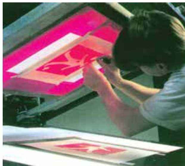
شکل ۲-۱۱- استفاده از استنسیل کاغذی
