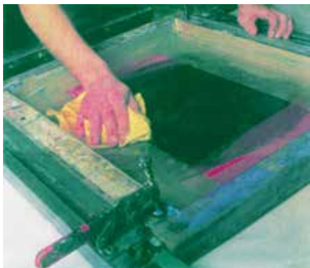
شکل ۶-۱۱- پاک کردن استنسیل به روش توش
