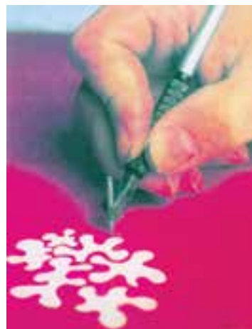
شکل ۷-۱۱- برش لایه ژلاتینی استنسیل برشی
