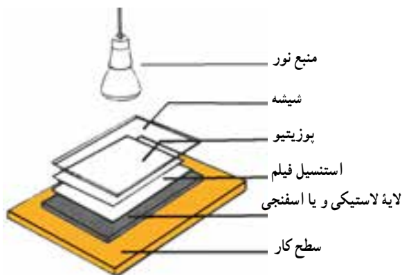
شکل ۱۲-۱۱- روش نورددهی استنسیل فتوکپی غیرمستقیم
