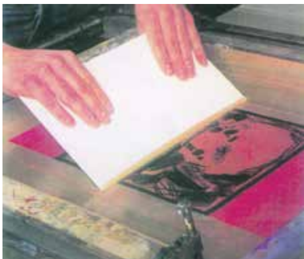
شکل ۵-۱۱- کسیدن صمغ عربی به درون توری با استنسیل توش
