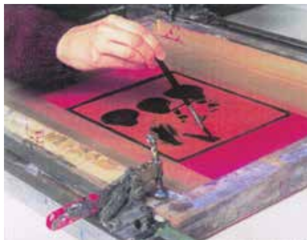
شکل ۴-۱۱- نقاشی بر سطح توری با استفاده از مرکب لیتوگرافی
