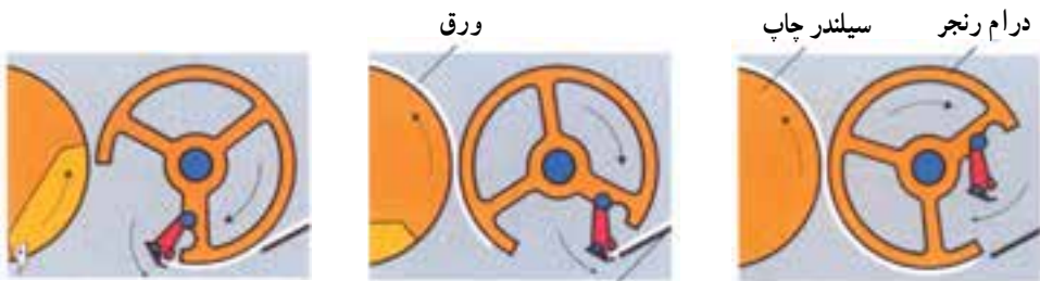
ب- ورق به آهستگی نسبت به سرعت تولید شتاب می یابد
