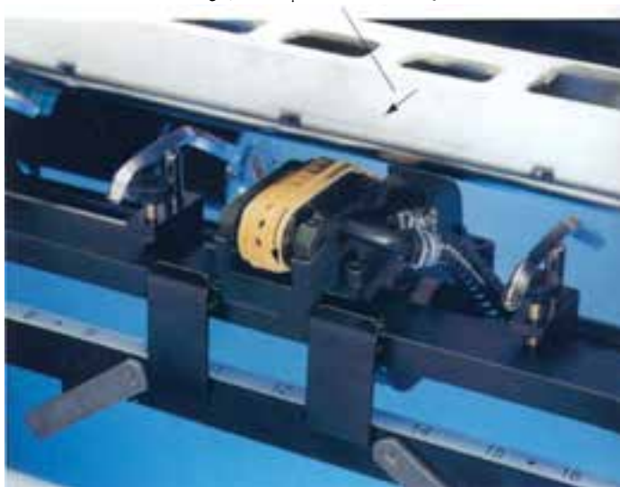
شکل ۳۳-۴— سیستم سرعت‌گیر ورق چاپی
