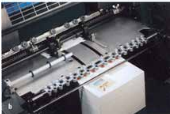
شکل ۴-۱- سیستم تغذیه تک‌برگی و نمودار انتقال ورق
