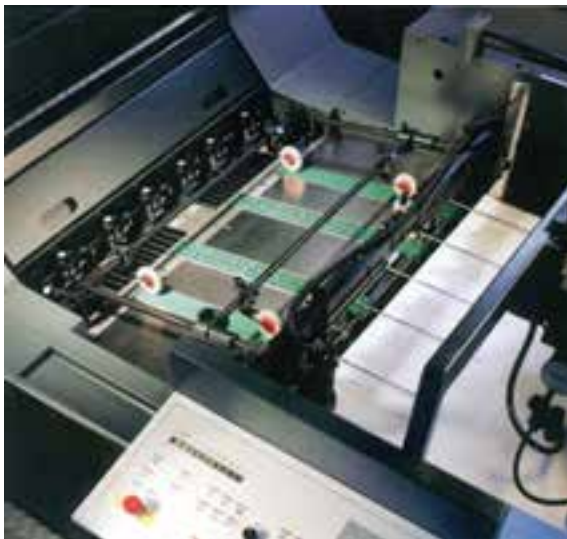
شکل ۵-۴— تغذیه پیوسته با میز مجهز به نوار مکنده
