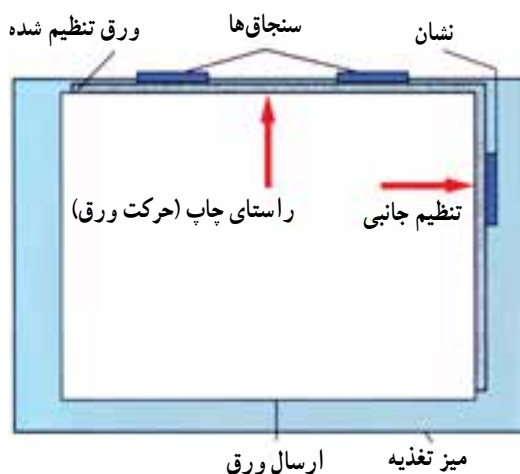
شکل ۶-۴- تنظیم راستای ورق توسط نشان و سنجاق‌ها
