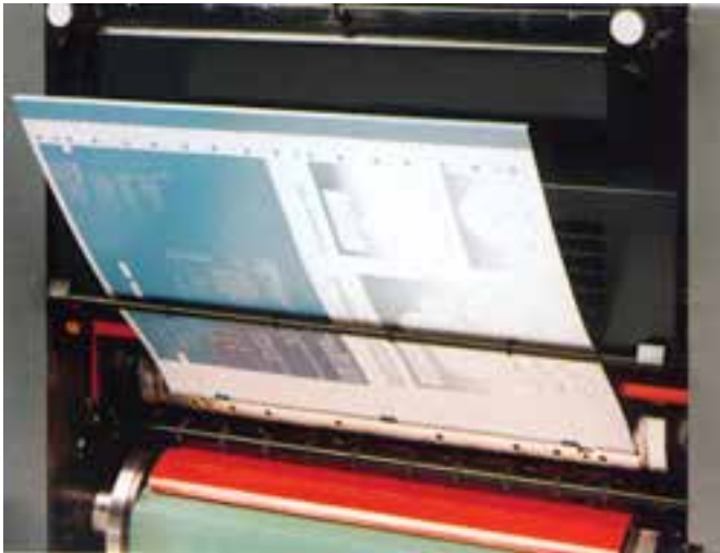
شکل ۲۰-۴- تعویض اتوماتیک پلیت
