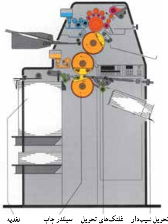
شکل ۳-۴- تحویل شیب‌دار روی ماشین چاپ کوچک تک‌رنگ افست
