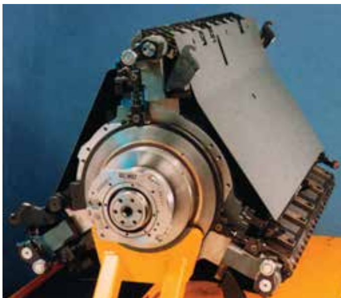
شکل ۴-۱۷— سیلندر انتقال سه برابر (حداکثر اندازه‌ی ورق)
