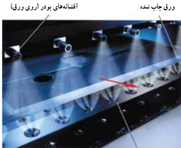
افشانه‌های پودر تعبیه شده روی سینی هدایت ورق (پشت ورق)
