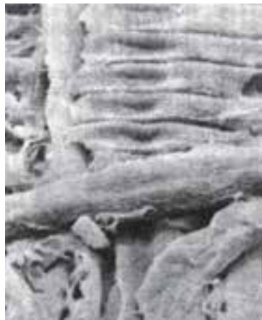
شکل ۱-۳- خمیر چوب آسیا شده با بزرگ‌نمایی ۴۲۰ برابر
