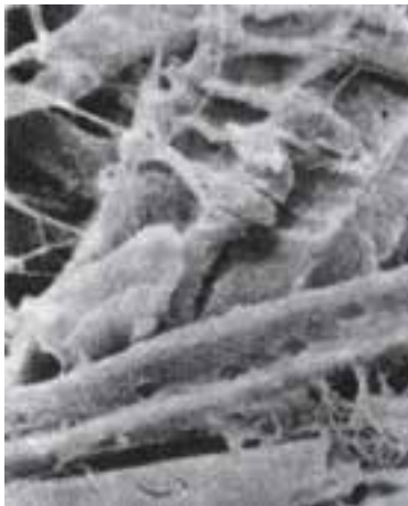
شکل ۳-۸ الیاف و فیبرهای بازیافتی کاغذ با بزرگ‌نمایی ۴۲۰ برابر
