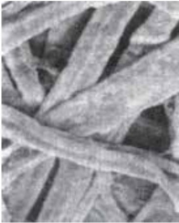
شکل ۵-۳- سلولز چوب مخروطداران با بزرگ‌نمایی ۴۲۰ برابر
