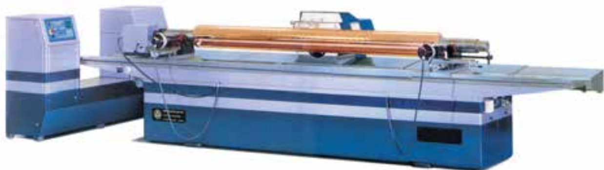
شکل ۵-۸ - دستگاه کپی مستقیم سیلندر
