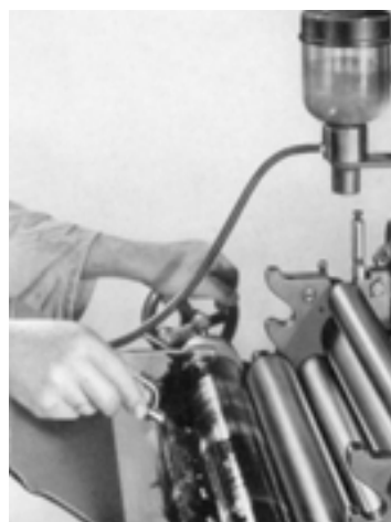
شکل ۱-۵ - ریختن مایع شست و شو دهنده روی سیلندر رنگ پخش کن
