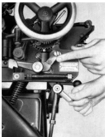
شکل ۴-۷- وصل کردن سیستم مرکب‌دهی
