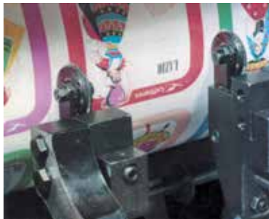
شکل ۴۵-۴ چرخ های پرفراژ که با پایه روی محور بسته شده اند ضمن کار دیده می شوند.
