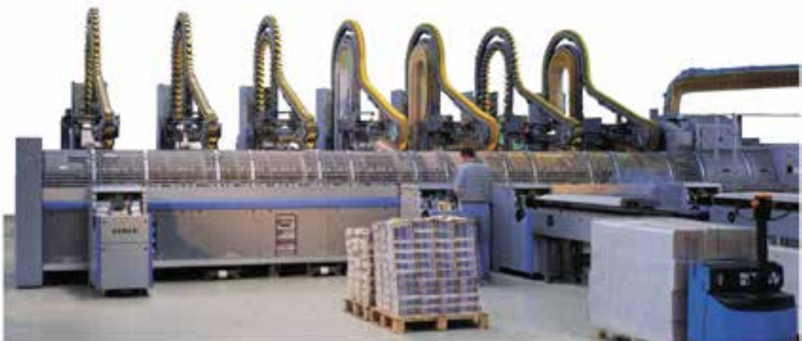
شکل ۴-۱۱- استوانه‌ی زینی دوخت مفتولی برای تولید مجله
