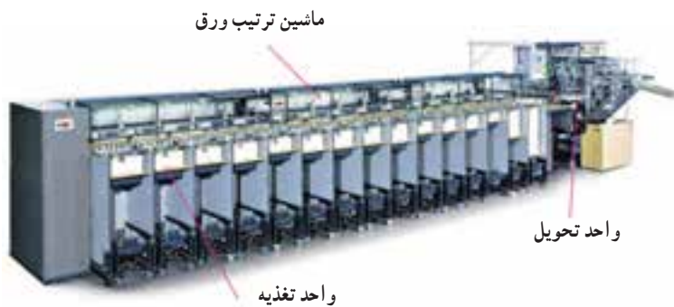
شکل ۴-۵- ماشین ترتیب با خط تغذیه افقی
