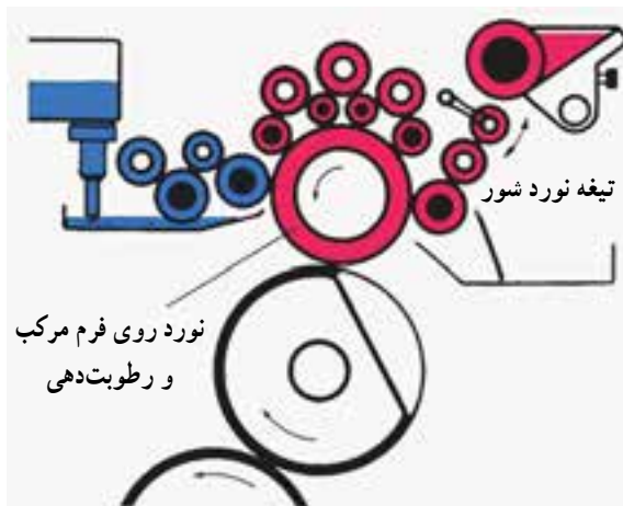
شکل ۱۰-۲- انتقال محلول رطوبت‌دهنده از طریق نورد مرکب
