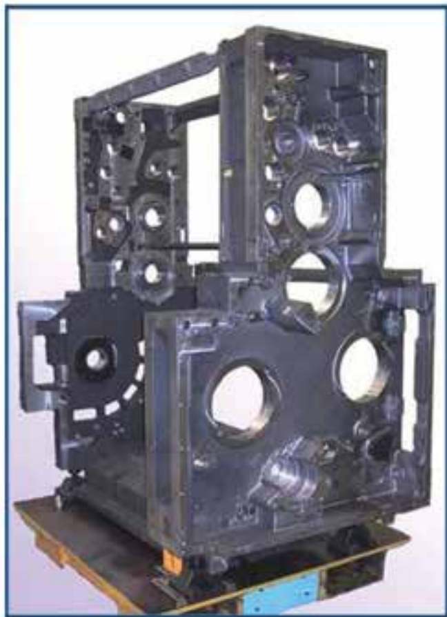
شکل ۲۲-۲- طراحی بدنه‌ی اصلی روی شاسی دستگاه
