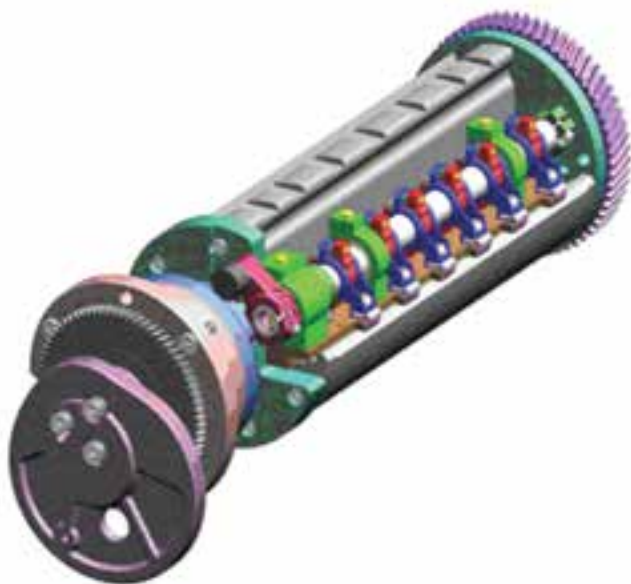
شکل ۲۳-۲- سیستم پنجه سیلندر فشار (چاپ) و اجزای تشکیل‌دهنده‌ی آن
