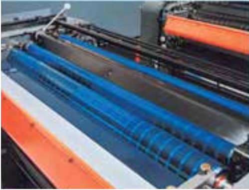
شکل ۱۹-۲- استفاده از فویل پلاستیکی برای حفاظت و تسریع در عملیات پاک‌سازی مرکب‌دان
