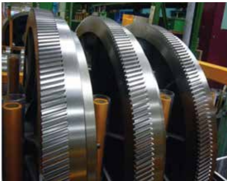
شکل ۲۱-۲- چرخ دنده‌های ویژه مورب (Helical Gear) با عمق زیاد
