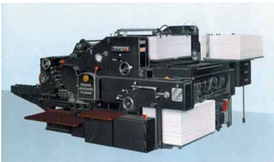
شکل ۹-۲. ماشین سیلندری دو رنگ (گرد و تخت)
