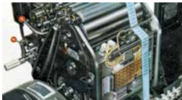
شکل ۲-۴- ماشین چاپ و طلاکوب تیگل در حال کار
