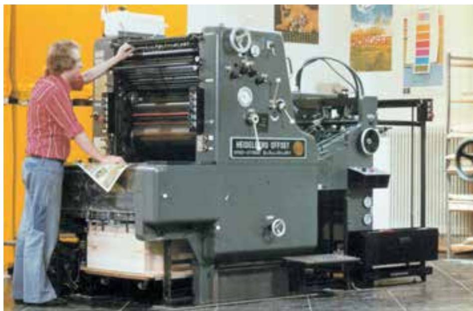
شکل ۱۵-۲- ماشین روتاسیون ورقی یک رنگ آفست یا لترست (برجسته)
