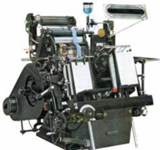
شکل ۲-۲- ماشین تیگل، سیستم بوستون معروف به ملخی
