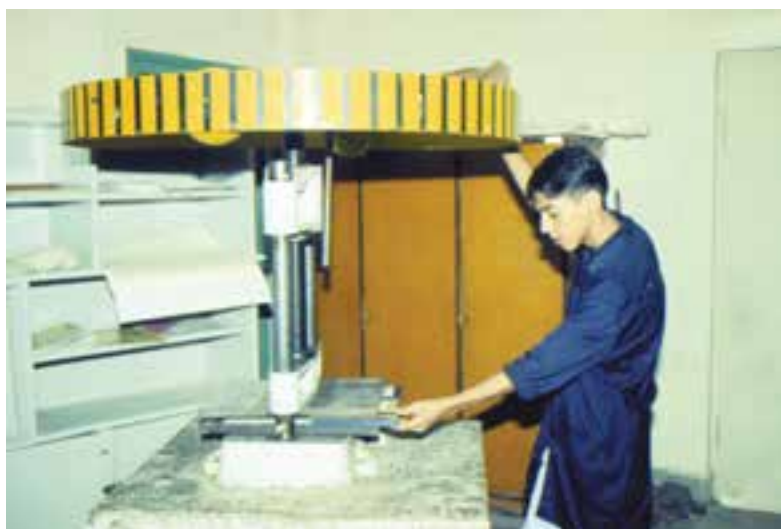
شکل ۱-۱۱- نمونه‌ای از پرس فلکه‌ای (دستی)
