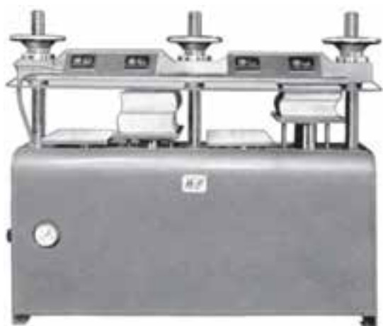
شکل ۱۳-۱- پرس فرم‌های کتاب توسط دستگاه پرس هیدرولیک
