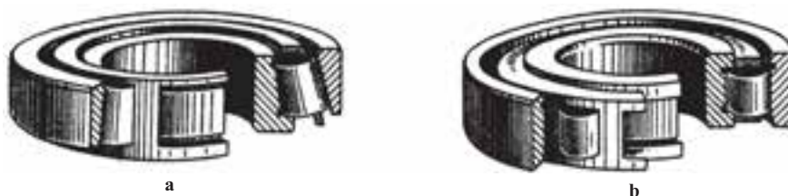
شکل ۷-۳۰- a- رولربرینگ مخروطی، b- رولربرینگ معمولی
