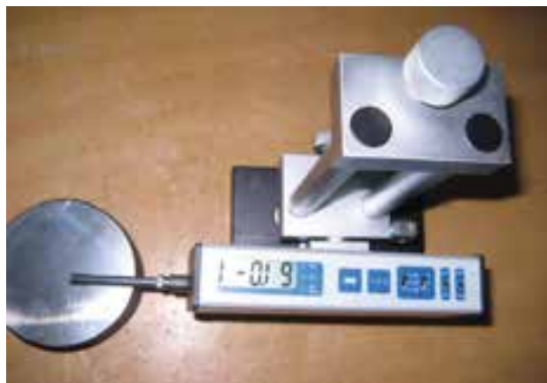
b - زبری سنج در حال اندازه‌گیری زبری
