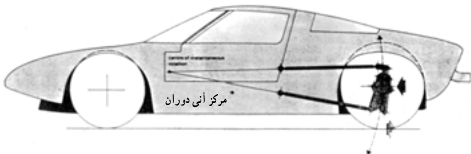
شکل ۶-۷- مرکز آنی دوران یا مرکز کله‌زنی خودرو
