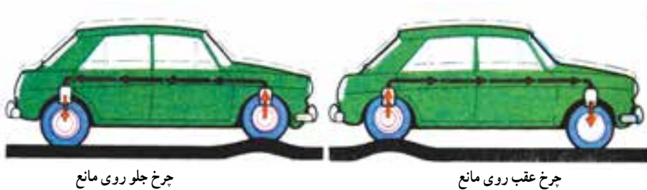
شکل ۳۰-۴- طرز عمل فنربندی هیدرواستاتیک
