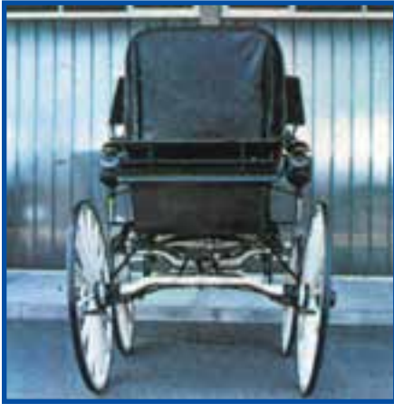
شکل ۴-۵- کاربرد فنر شمشی در درشکه
