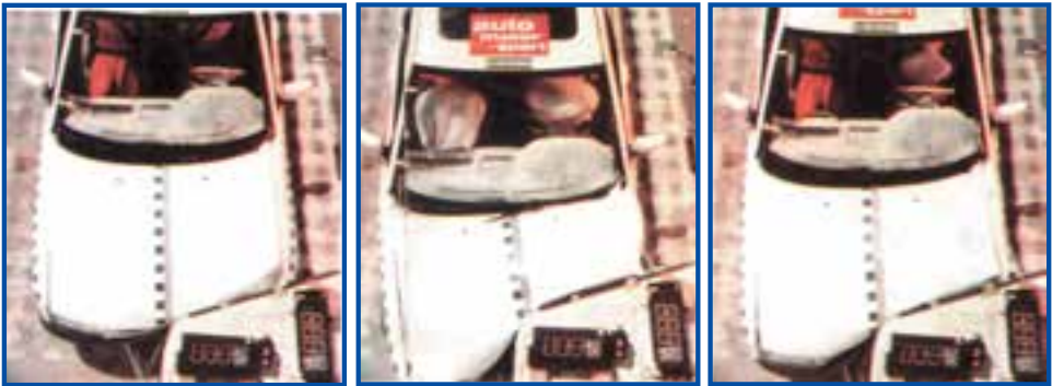
شکل ۱۲-۲- نحوه برخورد خودرو به مانع سیمانی ۱۵ درجه
