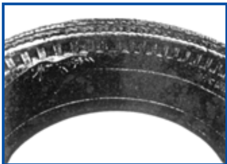
شکل ۲۷-۵ حرکت از روی مانع با لاستیک ترک دار، باعث ترکیدگی بیشتر آن می‌گردد.
