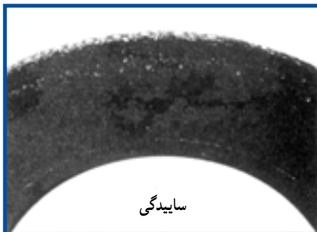
شکل ۲۸-۵ ساییدگی دیواره تایر در اثر تماس با اهرم‌بندی فرمان
