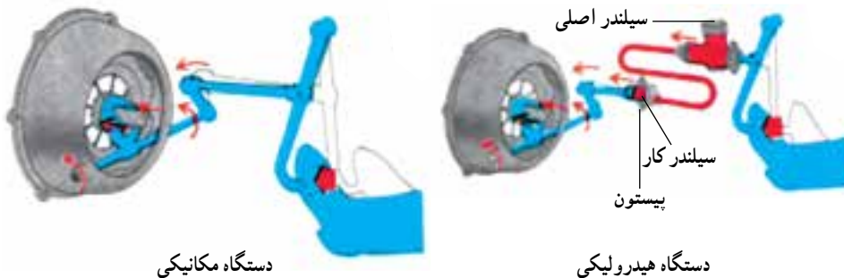
شکل ۱-۹- حرکت دستگاه کلاچ به وسیله پدال
