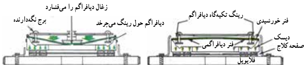
شکل ۱۴-۱- کلاچ خورشیدی در حالت خلاص
