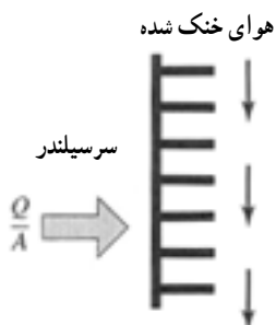
شکل ۵-۱۱- سیستم خنک‌کاری با سیال خنک‌کننده هوا
