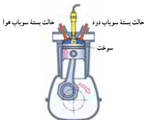
شکل ۳-۵- کورس تراکم، هر دو سوپاپ بسته هستند.
