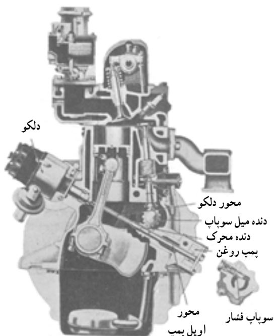
شکل ۱۴-۴- اوایل پمپ خارج از موتور قرار داشته و از میل سوپاپ نیرو می‌گیرد.
