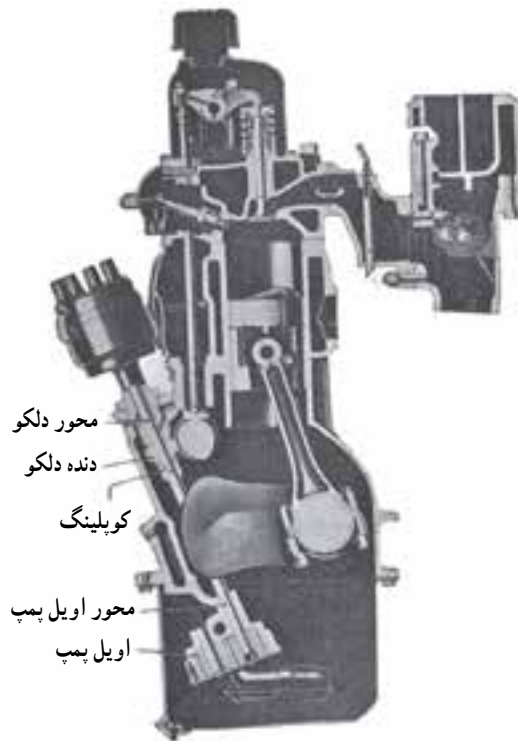
شکل ۱۵-۴- اویل پمپ داخل موتور بوده و از دلكو نیرو می‌گیرد.
